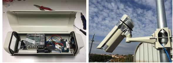
(A) INSIDE OF A CAMERA (B) THE COMPLETE CAMERA BOX
